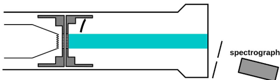
Slika 5.1: Shema aparature korištene u Ives-Stilwellovom eksperimentu. Preuzeto iz [23]
