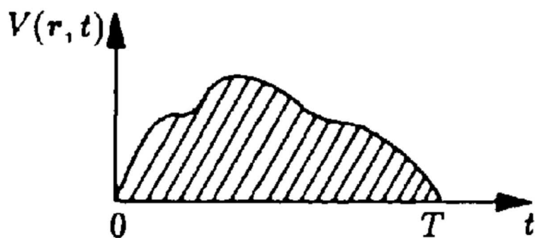
Slika 2.1: Opšti oblik perturbacija u toku vremenskog intervala [0, T] . Takva perturbacija može npr. biti uzrokovana vanjskim električnim poljem koje se uključi u toku tog intervala.
